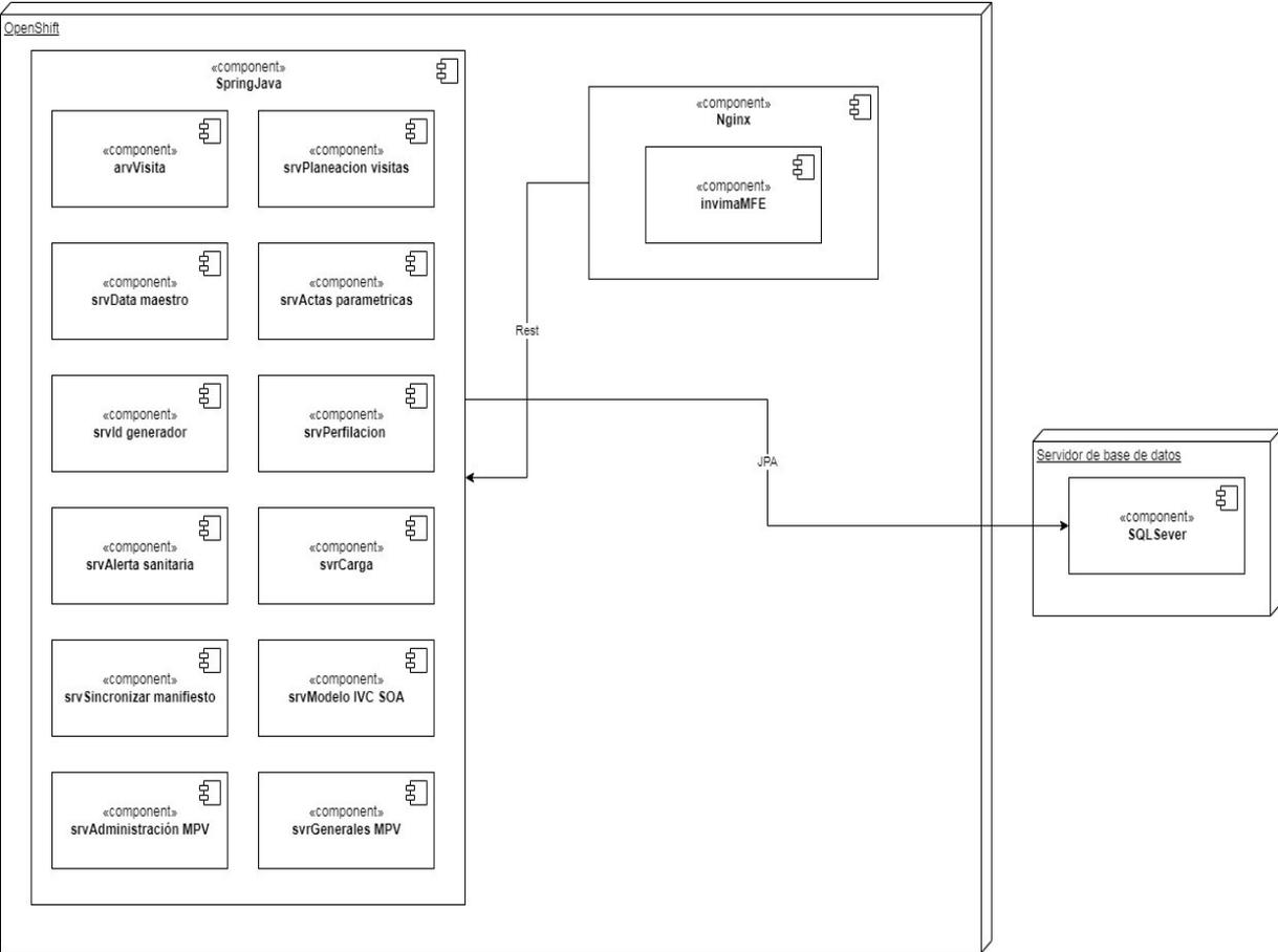
Ilustración 11 - Arquitectura De Solución Vista Física Sivicos
