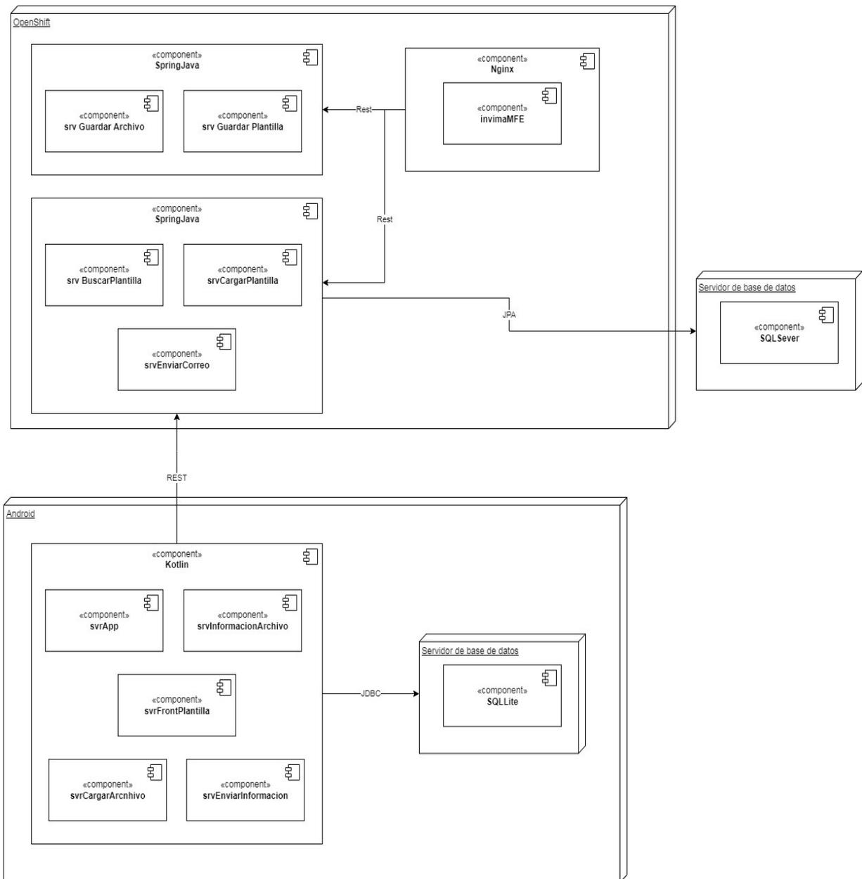
Ilustración 8 - Arquitectura De Solución Vista Física Actas Paramétricas
